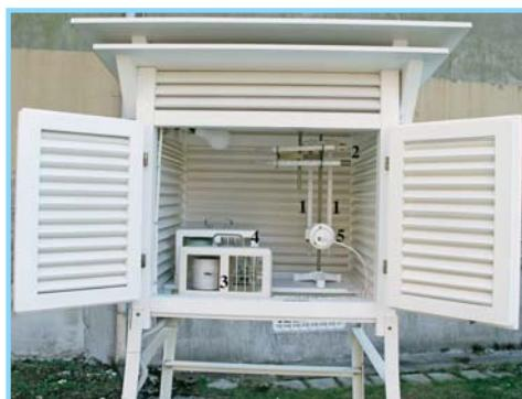
Raspored instrumenata u meteorološkoj kući: 1 - suhi i mokri termometar, 2 - minimalni i maksimalni termometar, 3 - termograf, 4 - higrograf, 5 - aspirator.
