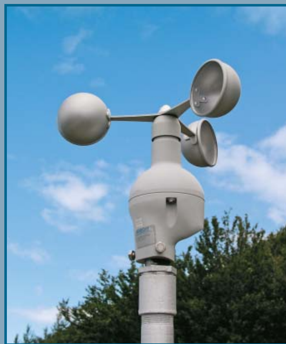
Anemometar – instrument za mjerenje brzine vjetra. Anemometer – instrument for measuring wind speed.
