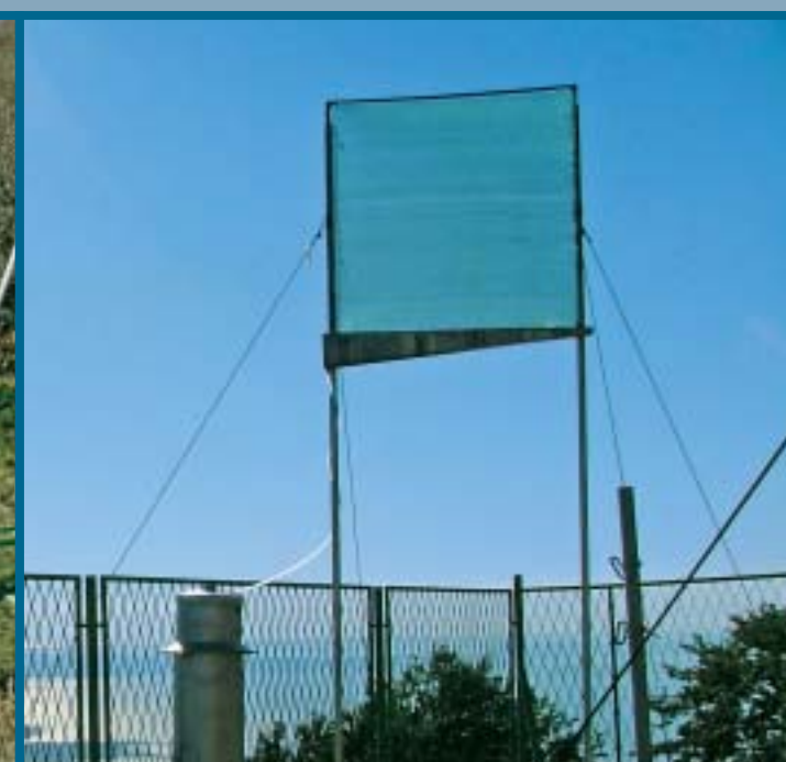
Skupljači oborine od magle postavljeni na Zavižanu nedaleko od meteorološke postaje. Fog precipitation collectors installed at Zavižan meteorological station.
