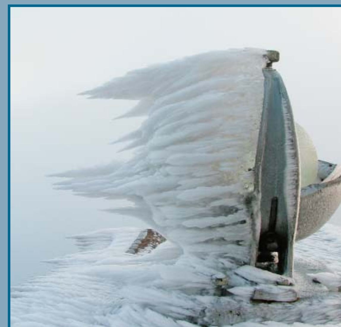
Nakupinainja na heliografu - uređaju za registraciju osunčavanja na meteorološkoj postaji Zavižan. Rime deposit on the instrument for sunshine registration at Zavižan weather station.
